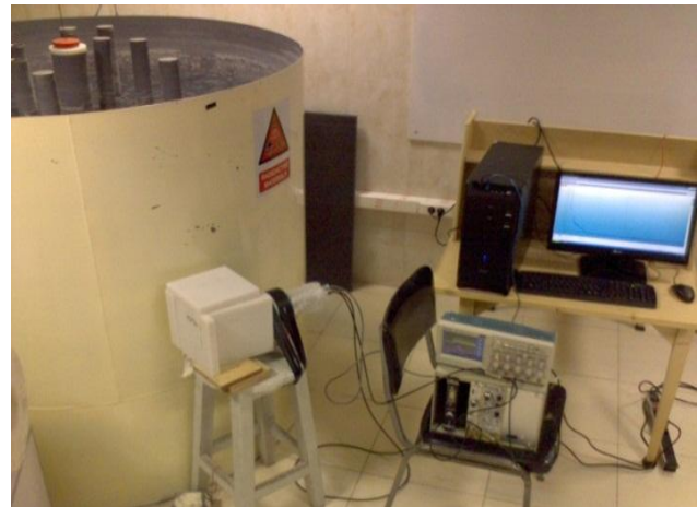
شکل ۲. چیدمان آزمایش PGNAA و تجهیزات طیف‌نگاری استفاده شده در آزمایشگاه نوترون شهید دکتر شهریار.
