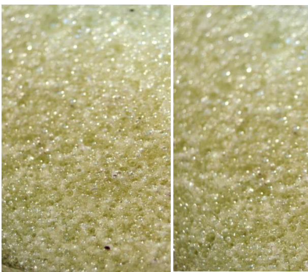
شکل ۱. دو سطح متقاطع جانبی شیشه‌ی سربی تحت عملیات حرارتی قرار گرفته به مدت ۳۰ دقیقه در دمای 900^{\circ}\text{C} .
