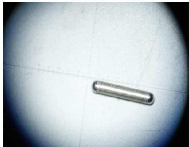
شکل ۲. تصویر لوله‌ی مسدود شده به روش ذوب لقمه و تی‌آی‌جی.
