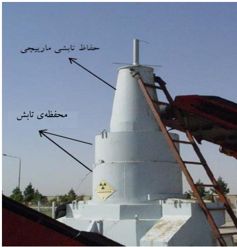
شکل ۱. سیستم پرتوده‌ی SVHI-CO-60-T و لوله‌ی PVC قرار گرفته در داخل آن.
