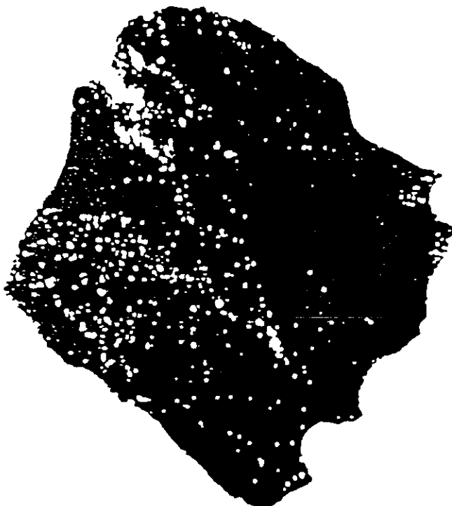
شکل ۲- ثبت اثر پرتوهای ساطع شده از نمونه سنگ پرتوزای منطقه چاه‌گر، ایران مرکزی بر فیلم پرتونگاری (بزرگنمایی ۴) این عکس از مقطع صیقلی نمونه G.4 تهیه شده است. (فتورادیوگرافی: توسط خانم شهرستانی، ۱۳۷۶)
