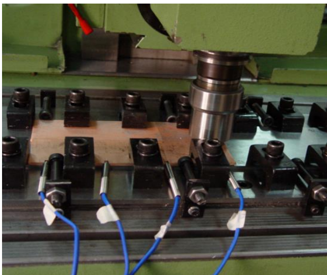
شکل ۲. موقعیت ترموکوپل‌ها در درون قطعه‌ی کار.
