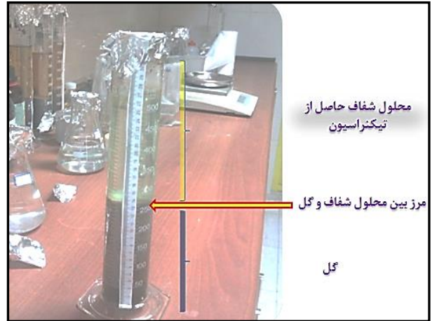
شکل ۳. عملیات ته‌نشینی گل و مایع شفاف بالای گل در غلظت‌های مختلف لخته‌ساز K-۳۰۰.
